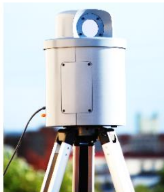
Рис. 7. Тепловизор с ИИ-распознаванием аномалий ГироВизор-Т
