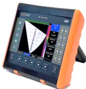
Рис. 2. Ультразвуковой дефектоскоп оснащенный фазированными решетками УСД-60ФР
