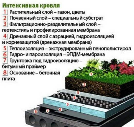
Рис. 2. Разрез интенсивной кровли
