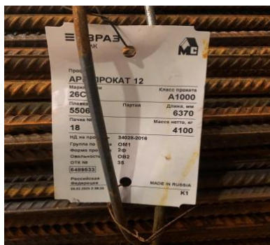
Рис. 2. Бирка завода-производителя арматурной стали
