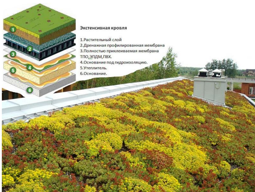
Рис. 1. Вид и структура экстенсивной кровли
